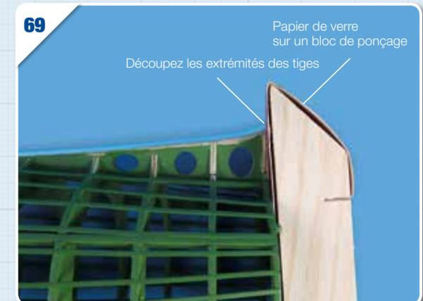
Découpez les extrémités des tiges sur la partie arrière de tout le module monté. Pour finir, poncez au papier de verre.
