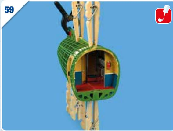
Assemblez et collez les deux moitiés. Assurez-vous que les axes soient parfaitement alignés. Maintenez le module assemblé avec des épingles à linge ou une paire de pinces pendant qu'il sèche.
