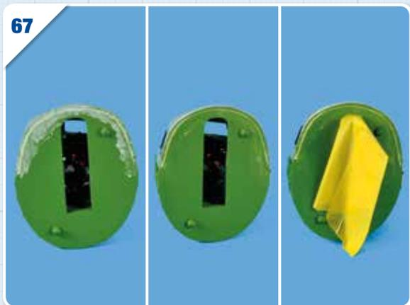
Remplissez, limez et repassez de la peinture sur les joints du module assemblé à l'étape 66. Si vous utilisez un aérographe, couvrez la porte pour éviter de peindre l'intérieur du cockpit. Pour plus de sécurité, couvrez aussi la partie avant du cockpit.
