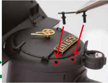
Appliquez du ruban adhésif synthétique aux extrémités des deux ferrures de la main courante B, et insérez-les dans les deux trous (encadrés).
