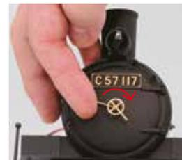
Lorsqu'on tourne le levier, le verrou de l'intérieur de la boîte à fumée tombe au centre de la barre de verrouillage et la porte est ainsi fermée.
