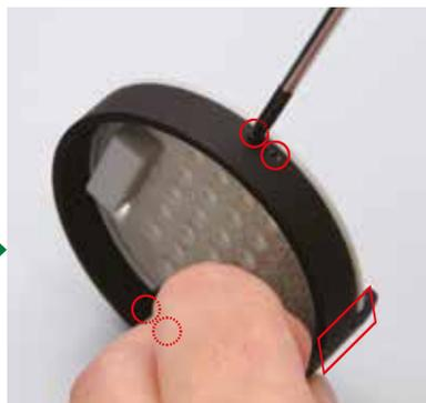
Taraudez les quatre trous des côtés du joint (cerclés) à l'aide de vis de 2 x 3 mm.
