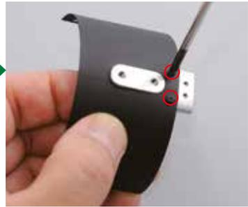
Serrez à demi une vis de 2 x 3 mm dans chacun des deux trous encerclés.
