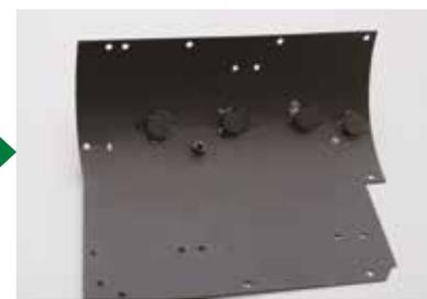
Appliquez une goutte de colle à base de caoutchouc synthétique au bout de la ferrure, puis serrez un écrou par-dessus.
