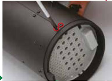
Serrez deux autres vis de 2 x 3 mm dans les deux trous placés de l'autre côté.
