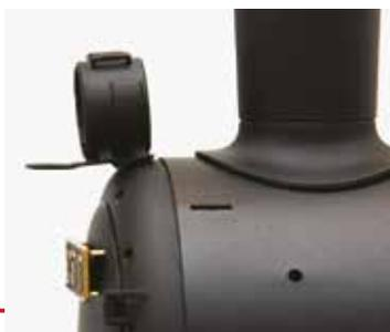
Ajustez la position du phare avant de façon à ce qu'elle soit identique à celle montrée ci-contre. Vérifiez qu'il est bien aligné sur le centre de la boîte à fumée.
