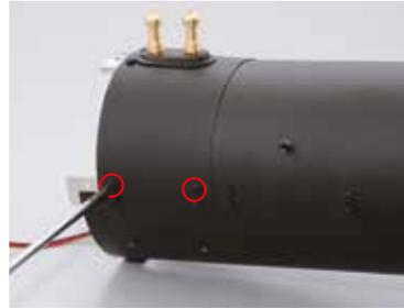
Serrez deux vis de 2 x 3 mm dans les trous du côté droit de la chaudière de façon à bien fixer la partie conique.
