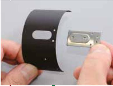
Placez la base des soupapes de sécurité à l'intérieur de la partie conique de la chaudière, en veillant à aligner les trous encerclés.
