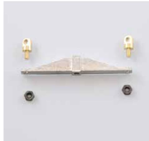
Disposez devant vous un ressort à lames, deux raccords de suspension et deux écrous, comme indiqué ci-dessus.
