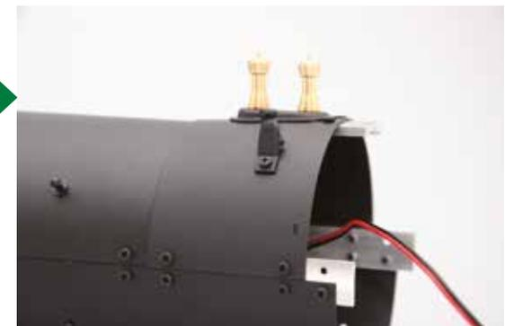
Serrez une vis de 2 x 3 mm dans les trous ainsi alignés.
