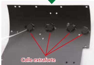
Appliquez maintenant de la colle extraforte sur la surface de contact située entre les bouchons et l'intérieur de la moitié de boîte à feu.
