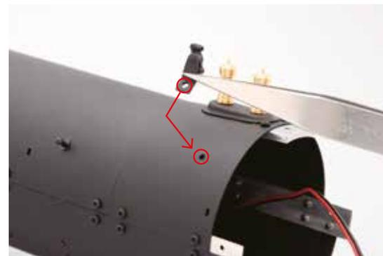
Alignez les trous de la partie conique de la chaudière et du levier du distributeur.
