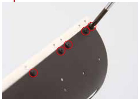
Fixez le second joint de chaudière à l'autre côté de la moitié inférieure de la chaudière à l'aide de sept vis de 2 x 3 mm.
