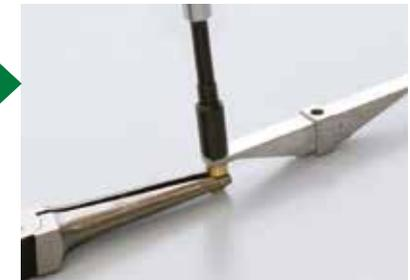
Introduisez la partie filetée du raccord dans le trou du ressort à lames et serrez un écrou par-dessus.
