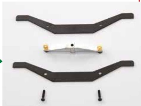
Disposez l'un des ressorts à lames entre une traverse intérieure et une extérieure, accompagnez le tout de deux vis à tête hexagonale de 2 x 8 mm.
