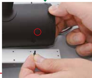
Appliquez une peu de colle à base de caoutchouc synthétique sur la partie fileté des ferrures, puis insérez celles-ci dans les deux trous encerclés. Fixez-les à l'aide des deux écrous.
