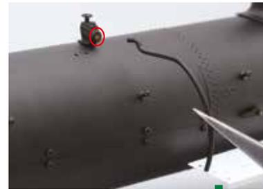
Appliquez un peu de colle à base de caoutchouc synthétique au bout du conduit d'alimentation en eau et insérez ce dernier dans le trou de la soupape.
