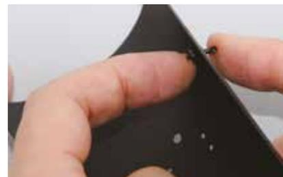
Appliquez un peu de colle à base de caoutchouc synthétique à l'intérieur de la moitié de chaudière à la base de la ferrure, et vissez un écrou à son extrémité.
