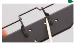
Si vous apercevez un excès de colle sur le balancier avant, prenez un objet pointu –un cure-dents, par exemple– pour le retirer avant qu'il ne sèche.
