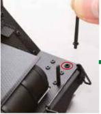
Avec de la colle multiusages, collez l'une des barres d'appui dans le trou encerclé situé sur le côté gauche du pont avant.
