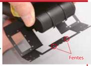
Alignez les extrémités des deux bandes sur les deux fentes du pont avant.
