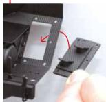
Mettez le couvercle de regard B en place en partant de l'arrière du pont avant.
