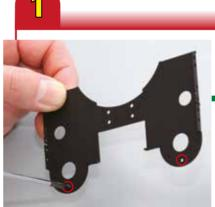
Serrez une vis de 2 x 3 mm dans chacun des deux trous ci-dessus encerclés, situés dans la plaque arrière du cylindre.
