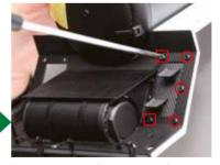
Serrez trois vis de 2 x 3 mm dans les trous situés sur le côté du pont (encerclés), puis finissez de serrer les vis des trous intérieurs (encadrés). Effectuez la même opération pour le côté droit du pont avant.
