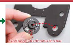
Appliquez de la colle multi-usages à l'arrière de l'un des deux couvercles de cylindre. Puis placez-le sur l'un des bras de la plaque arrière, comme montré ci-dessus, en vous servant de la vis comme goupille d'assemblage.
