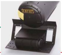
Serrez une vis de 2 x 5 mm dans les trous situés derrière les crochets sur le pont avant (voyez les flèches).
