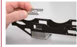
Retournez le châssis assemblé et placez le support de boggie entre ses côtés, sous le support de la chambre à fumée.
