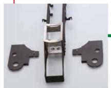
La plaque de cylindre avant est divisée en deux parties. La face avant des plaques est plate.
