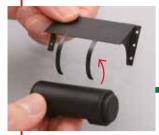
Placez les deux bandes du support du réchauffeur sur le réchauffeur d'eau d'alimentation.
