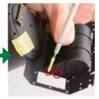
Puis serrez une autre vis de 2 x 2 mm dans les trous encerclés.
