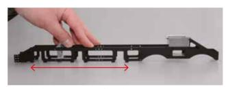
Placez le châssis sur une surface plane, comme indiqué cidessus, et pressez légèrement dessus pour vérifier que le bas repose bien à plat à l'endroit délimité par les flèches.
