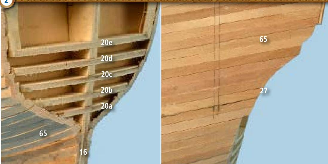
**2** Les bords des baguettes 65 doivent être bien alignés aux profils de la fausse-quille 16, des supports 20a, 20b, 20c, 20d, 20e et des parois latérales inférieures 27.
