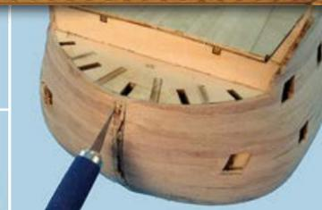
5 A l'aide d'un cutter bien aiguisé, creusez une rainure en correspondance des deux lignes dessinées sur la coque. Regardez l'étape suivante avant de continuer.
