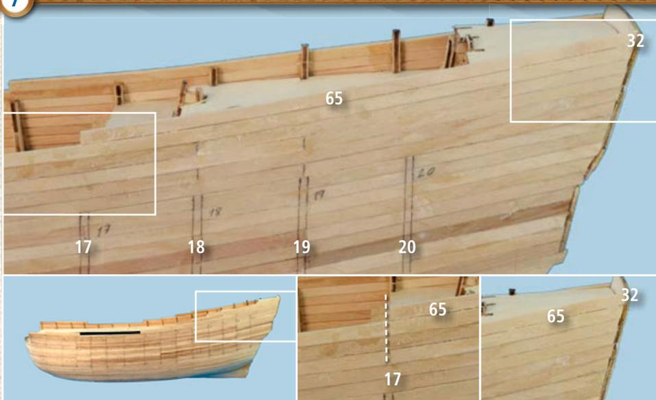
**7** Collez une baguette 65 aux baguettes de la rangée inférieure en faisant en sorte que l'extrémité avant soit bien alignée avec le prolongement de la membrure 17 et que l'extrémité arrière soit alignée avec la paroi du tableau arrière 32. Répétez l'opération sur le côté droit de la coque.
