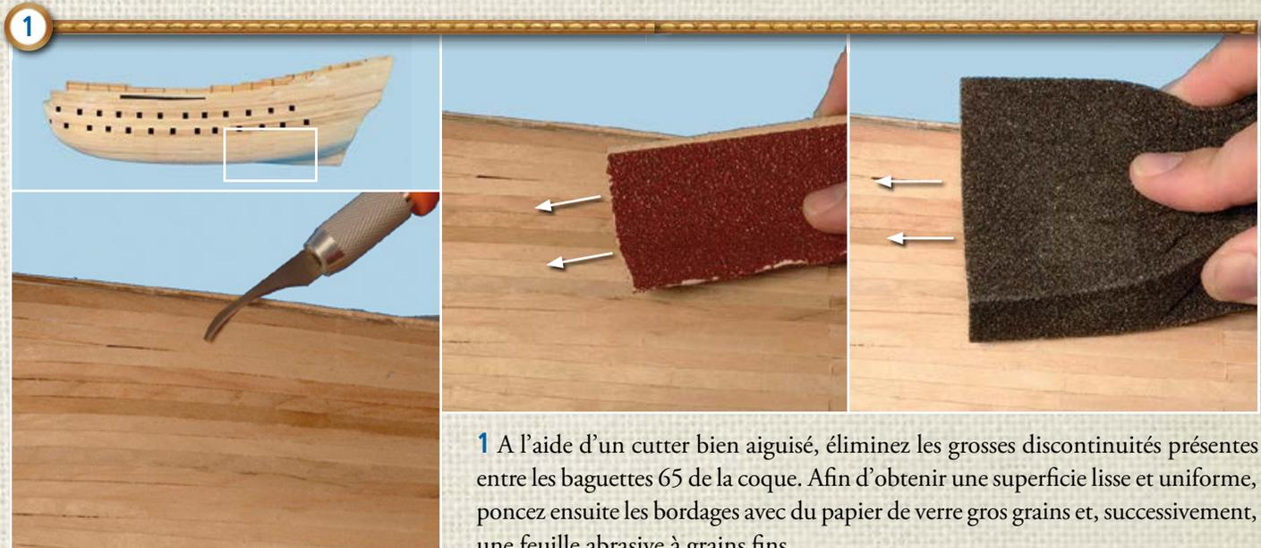
**1** A l'aide d'un cutter bien aiguisé, éliminez les grosses discontinuités présentes entre les baguettes 65 de la coque. Afin d'obtenir une superficie lisse et uniforme, poncez ensuite les bordages avec du papier de verre gros grains et, successivement, une feuille abrasive à grains fins.
