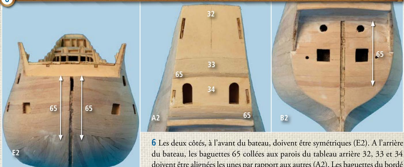
**6** Les deux côtés, à l'avant du bateau, doivent être symétriques (E2). A l'arrière du bateau, les baguettes 65 collées aux parois du tableau arrière 32, 33 et 34 doivent être alignées les unes par rapport aux autres (A2). Les baguettes du bordé à l'arrière du bateau doivent former une surface lisse et uniforme (B2).
