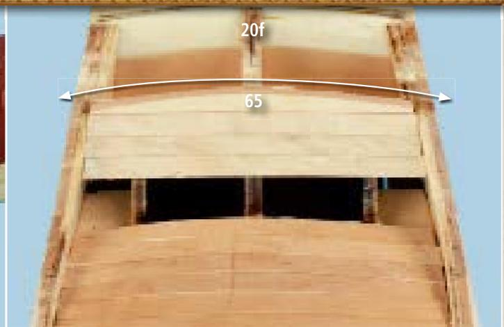
**12** Poncez la dernière baguette 65 posée durant la phase 11 de manière à ce qu'elle soit centrée avec la paroi 20f et que ses extrémités soient alignées avec le profil latéral de la coque.
