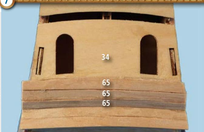
7 Terminez de tapisser en collant trois autres baguettes 65 aux éléments 20f, 29 et 27. Remplissez l'espace entre la dernière baguette 65 et l'extrémité inférieure de la paroi du tableau arrière 34 avec un morceau de baguette façonné comme il faut.
