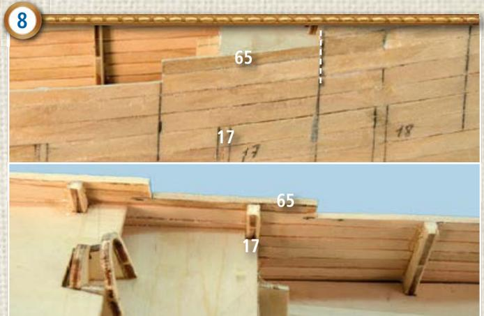
**8** Poncez la baguette 65 placée sur la membrure 17 pour la niveler avec la membrure et pour la rendre parallèle au profil du pont. Coupez les baguettes sur le côté droit de cette section du bordé au niveau de la ligne tracée à côté de la membrure 17.
