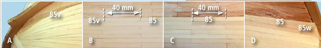
**1** Façonnez une baguette 85 comme il est indiqué dans l'encadré (pièce 85u). Retournez la maquette et partez de l'avant du bateau pour coller, sur le côté droit, l'élément 85u et deux autres baguettes 85 au-dessus de dernière rangée installée durant l'étape 51. Les jonctions des baguettes de la nouvelle rangée doivent être décalées de 40 mm par rapport à celles de la rangée précédente.
