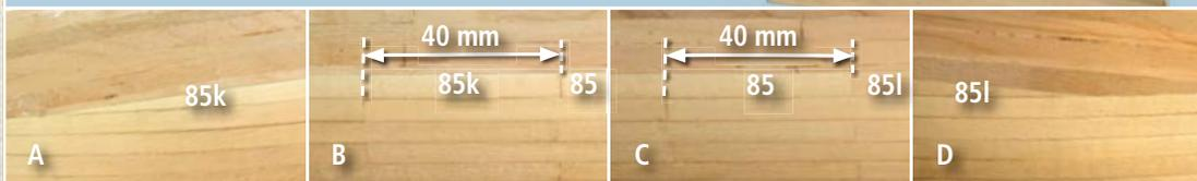
**2** Façonnez deux baguettes 85, que nous appellerons 85k et 85l, comme il est indiqué dans l'encadré. En démarrant de l'avant du bateau, collez la pièce 85k, une baguette 85 et la pièce 85l au-dessus de la rangée installée à la phase 1. Les jonctions des baguettes doivent être décalées de 40 mm de celles de la rangée inférieure.
