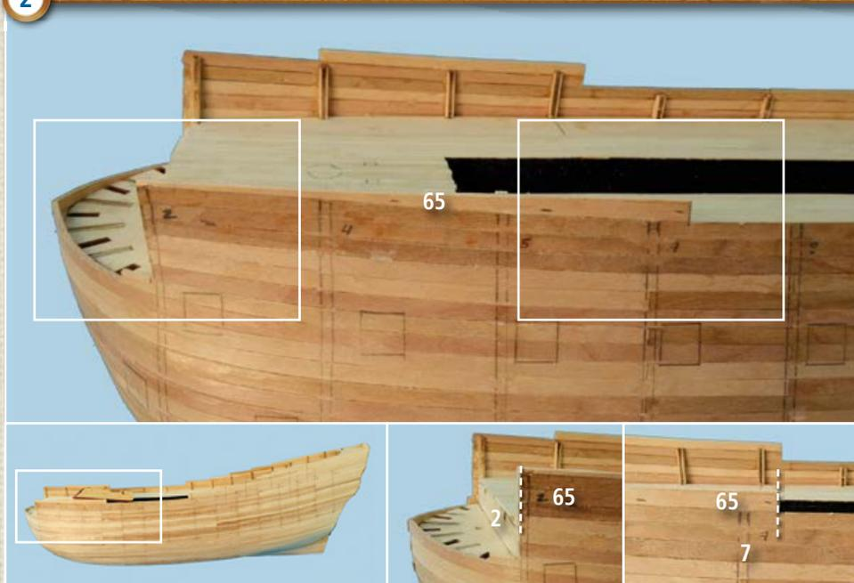
**2** Poncez les baguettes 65 qui sont placées sur les membrures 2, 4, 5 et 7 avec un bloc à poncer jusqu'à ce qu'elles soient parfaitement alignées avec les bords supérieurs des membrures. Coupez les extrémités arrières des deux baguettes 65 au niveau de la ligne tracée pendant la phase 1, juste à côté de la membrure 7. Effilez ensuite les bords des baguettes 65 qui dépassent de la membrure 2 et alignez-les au bord latéral de la même membrure 2.
