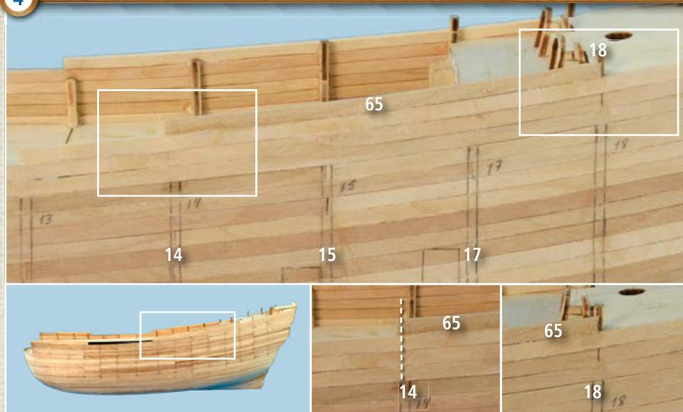
**4** Collez une baguette 65 aux membrures 17 et 18 et à la baguette placée en dessous. L'extrémité avant de la baguette doit être alignée au prolongement de la membrure 14, tandis que l'extrémité arrière doit arriver à la moitié de l'épaisseur de la membrure 18. Répétez l'opération sur le côté droit de la maquette.
