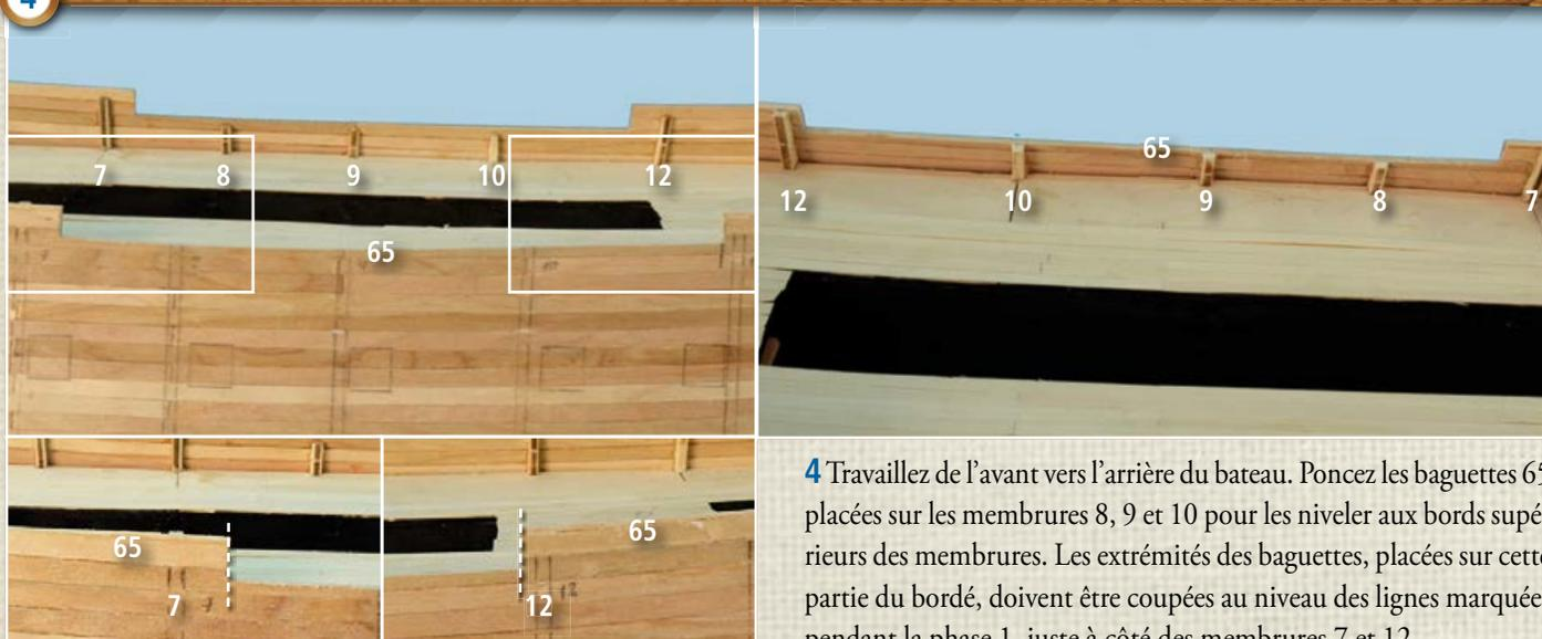
**4** Travaillez de l'avant vers l'arrière du bateau. Poncez les baguettes 65 placées sur les membrures 8, 9 et 10 pour les niveler aux bords supérieurs des membrures. Les extrémités des baguettes, placées sur cette partie du bordé, doivent être coupées au niveau des lignes marquées pendant la phase 1, juste à côté des membrures 7 et 12.
