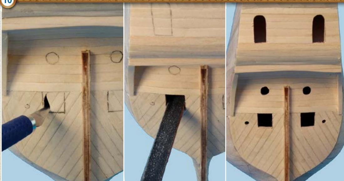
**10** A l'aide d'un cutter, coupez les sabords des batteries, les fenêtres et les sabords ronds. Poncez ensuite soigneusement les bords des ouvertures avec des limes de formes différentes. Utilisez la même technique expliquée à la phase 13, étape 45 des instructions de montage.
