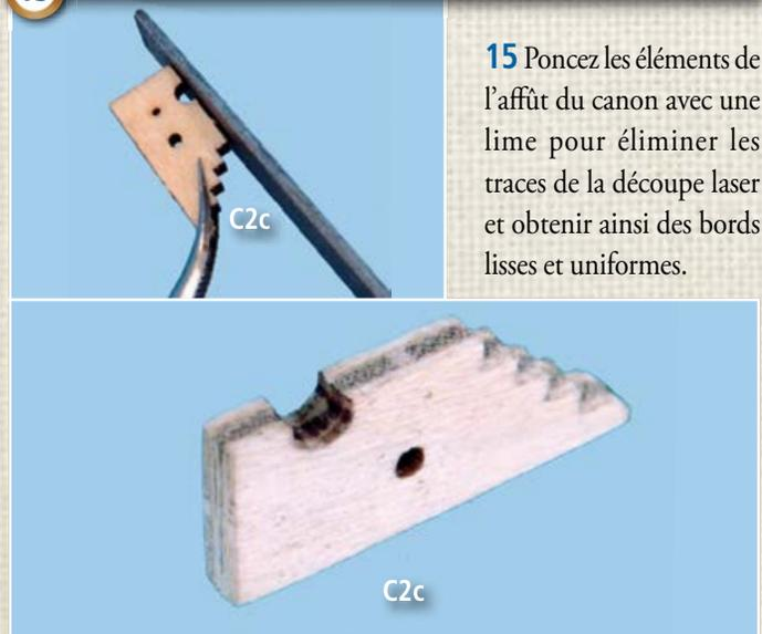
**15** Poncez les éléments de l'affût du canon avec une lime pour éliminer les traces de la découpe laser et obtenir ainsi des bords lisses et uniformes.
