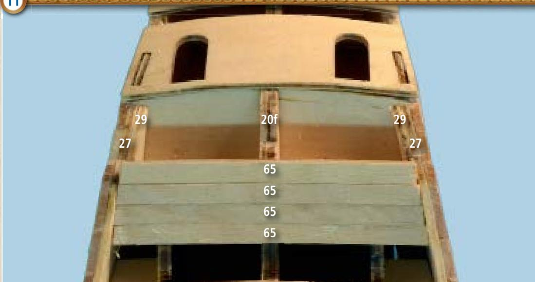
**11** Placez trois baguettes 65 au-dessus de la baguette de la phase 10, en les installant toujours entre les parois latérales 27. Collez-les à la paroi centrale 20f et aux renforts latéraux 29.
