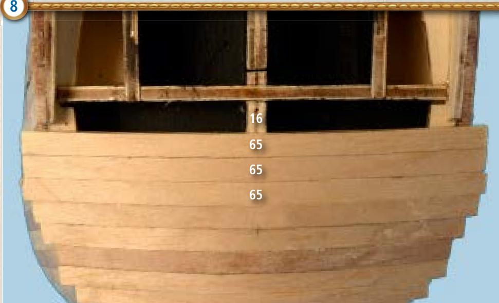
8 Placez maintenant trois baguettes 65 sur le haut de la baguette de la phase 5 en les collants à la fausse-quille 16 et aux baguettes du bordage latéral. Dans ce cas là aussi, les bords des baguettes doivent légèrement dépasser le profil du bordage.
