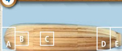
4 Toujours à l'aide d'un crayon à papier, tracer le long de la coque deux lignes parallèles à une distance de 4 mm l'une de l'autre. Les lignes doivent être centrées et coïncider avec les lignes des pièces de la fausse-quille 1, 6, 11 et 16 qui se trouvent en-dessous du bordé.
