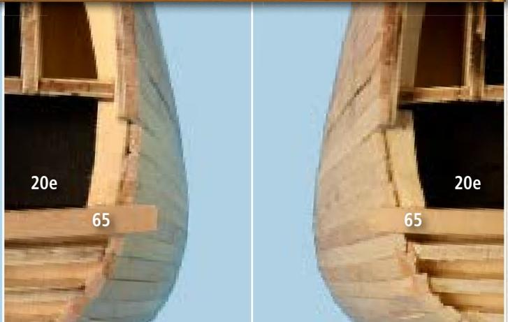
5 Collez le morceau de baguette 65 en l'alignant au bord supérieur du support 20e. Collez-le aussi aux baguettes du bordage de la coque.
