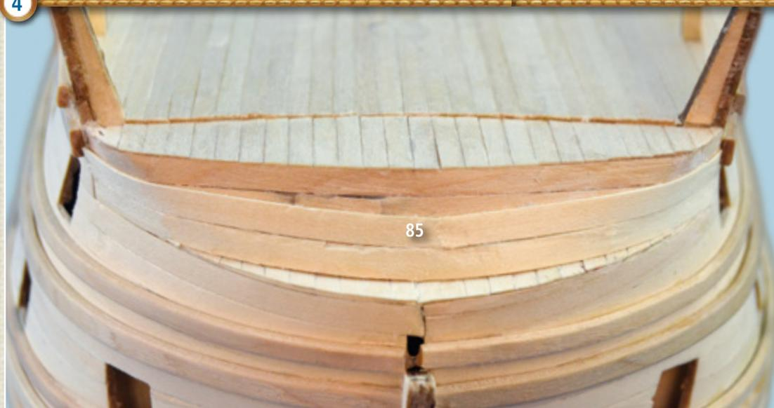
**4** Façonnez maintenant un deuxième morceau de baguette 85, cintrez-le et collez-le sur la baguette installée durant la phase 2. Dans ce cas là aussi, les extrémités de la baguette 85 doivent parfaitement coïncider avec les baguettes du bordage.
