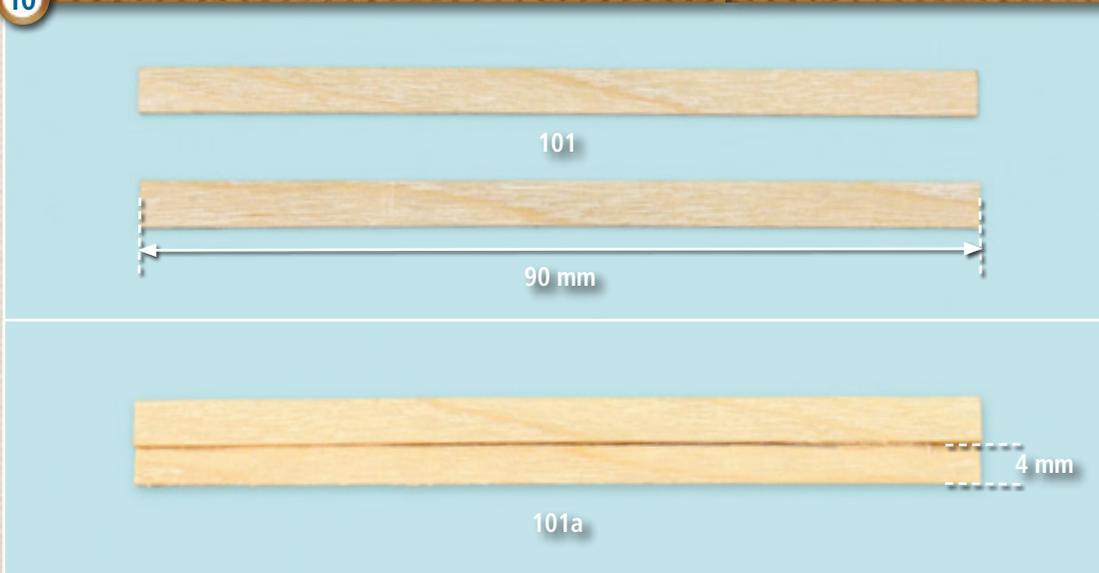
**10** Coupez deux petits morceaux de baguette 101 d'environ 90 mm de longueur. Collez ensuite entre elles les baguettes en les superposant d'1 mm dans le sens longitudinal. Nous identifierons l'union de ces deux pièces comme «baguette 101a».
