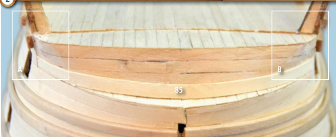
**2** Façonnez un morceau de baguette 85 et, après l'avoir dument cintré, collez-le en position horizontale sur la partie inférieure de la paroi avant du bateau. Observez bien la phase 3 avant de continuer le montage.
