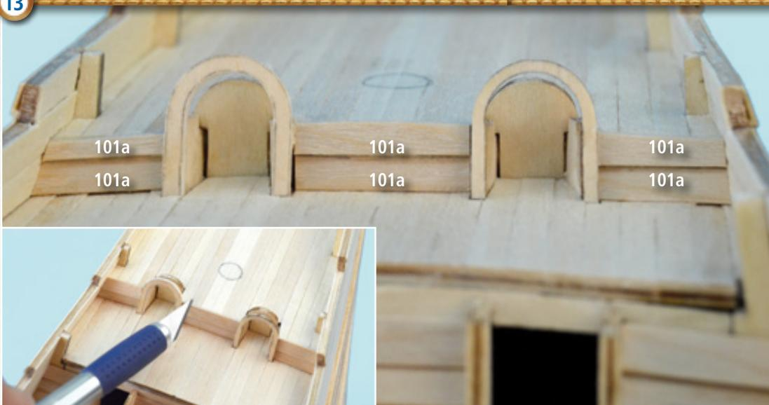
**13** À l'aide d'un cutter, effilez ensuite les bords supérieurs des baguettes 101a en les alignant avec le panneau de la dunette.
