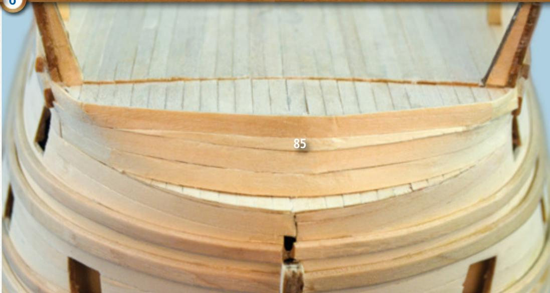
**6** Pour compléter le revêtement de la paroi avant, vous devez prendre un morceau de baguette 85 qui n'a pas été utilisé et préparer une pièce de remplissage façonnée comme il faut. Collez la pièce de remplissage dans l'espace de la paroi qui n'a pas encore de baguettes 85.
