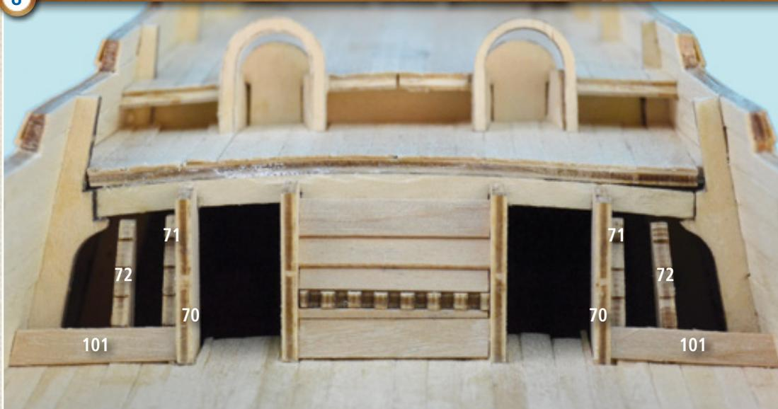
**8** Coupez et façonnez comme il faut deux baguettes 101 à appliquer de chaque côté des parois latérales. Placez les baguettes entre les montants 70 et les bastingages en les encastrant dans les encoches inclinées des pièces 71 et 72.
