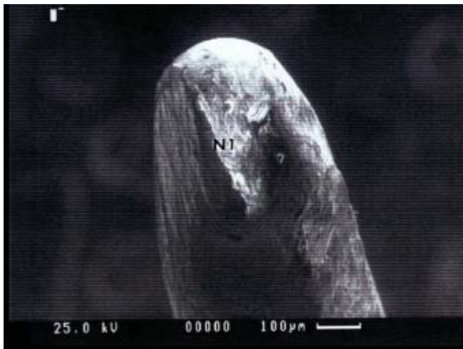
圖二十、負極電線N端斷裂面的SEM相片。斷裂面被壓擠變形，近似扁三角形。
