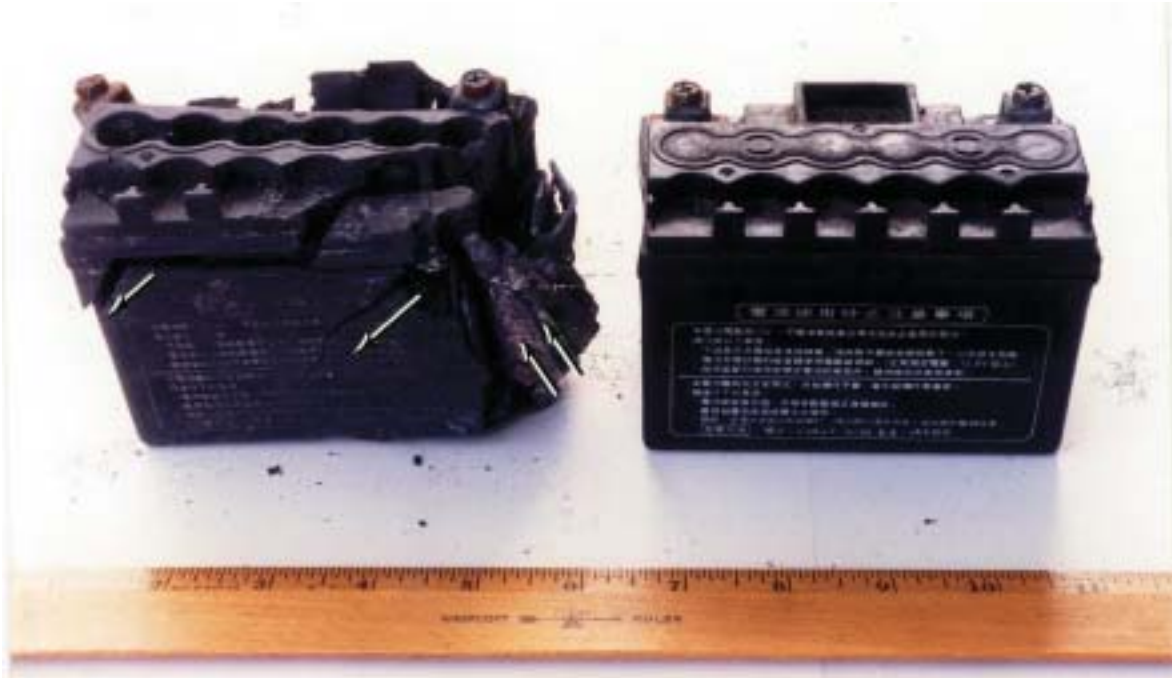
圖1.14-1 左為座位5C下方發現之電池，右為同型號完好電池。
