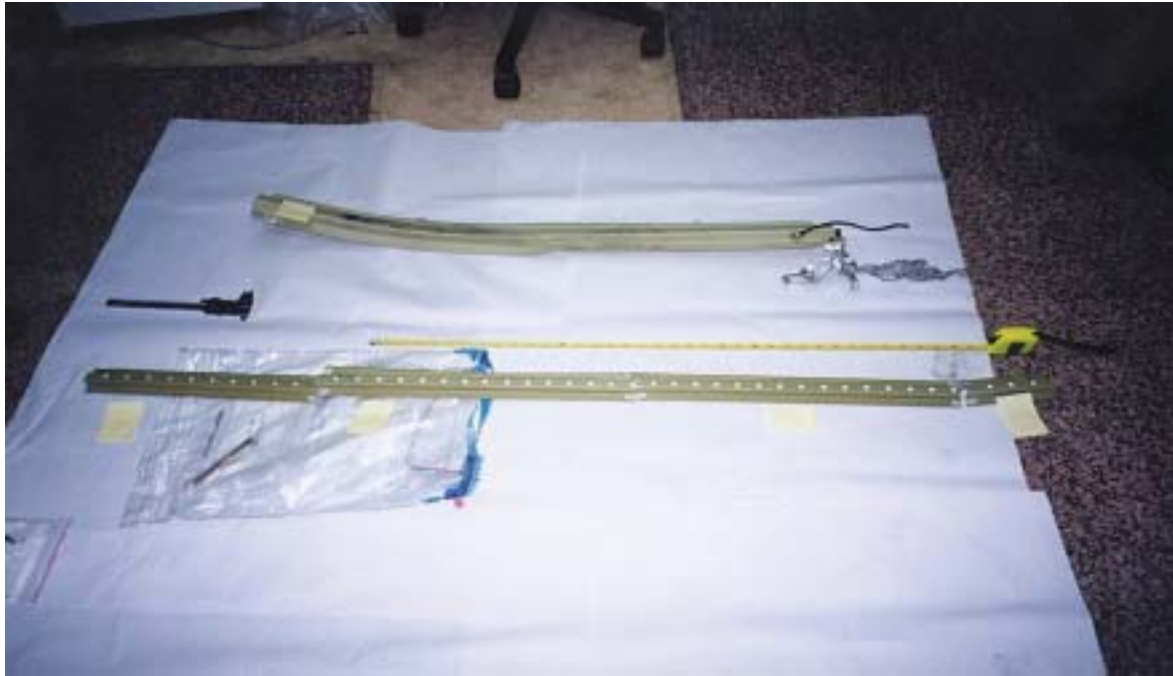
圖1.12-9 跑道上之縱樑及置物箱軌道橫桿（無火燒痕跡）
