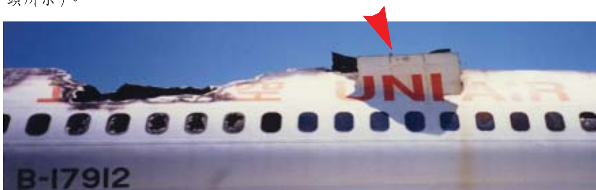
圖1.12-4 側裂蒙皮外觀
