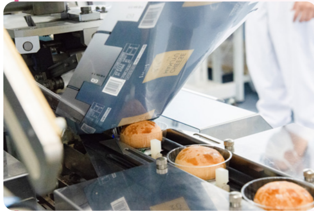
1分間に約100袋を 包装できる上、接着 不良も発生しない。
