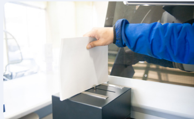
冊子の厚さも自動で計測。自動化されたことで品質も安定し、不良率が5%から1%に低下。
