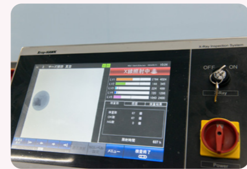
包装機には同時導入したX線異物検査機が 連結されている。
