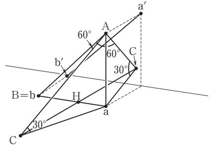
たものを立面図，平面図（水平画面）に投影したものを平面図，という。また，実際の点を A, B で表し，それらを平面図に投影した点を a, b で表し，立面図に投影した点を a', b' で表す。
