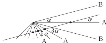
したがって, OA と  $(2n+1)\alpha^\circ$  の角で発射すると, 壁で  $2n$  回反射する。ただし,  $(2n+1)\alpha^\circ < 180^\circ$  でなければならない。
