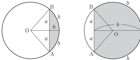
中心が  $O$ 、弓形の弧を  $\widehat{AB}$  とする。左図は中心角  $\angle AOB$  が  $180^\circ$  以下の場合で、右図は  $180^\circ$  以上の場合である。
