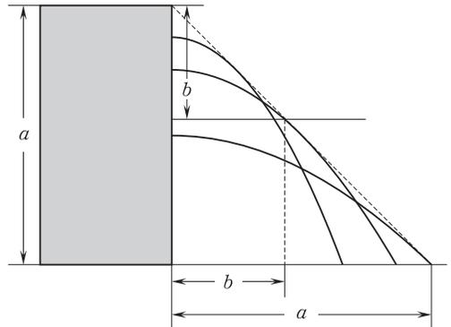
したがって、床に平行で水面の下  $b$  cm の位置ある平面を水が通過する範囲は壁から  $b$  cm の点までの範囲である。
