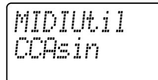
4. パラメーター・ディスプレイに“CCAssign”と表示され、パリュウ・ディスプレイには“(対応するツマミの名前)”が表示されます。ダイアルを回して設定を行うツマミを選択し、キー 12を押します。
