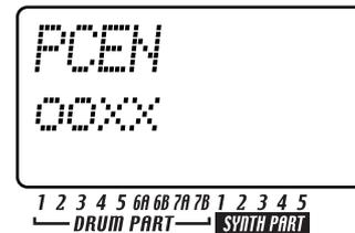
“ PCEN ”表示はバリユー・ディスプレイの および×に左から一つずつ対応します。ダイヤルを回してディスプレイの表示で送受信するメッセージは“ ”、しないメッセージは“ x ”の組み合わせを選びます。
