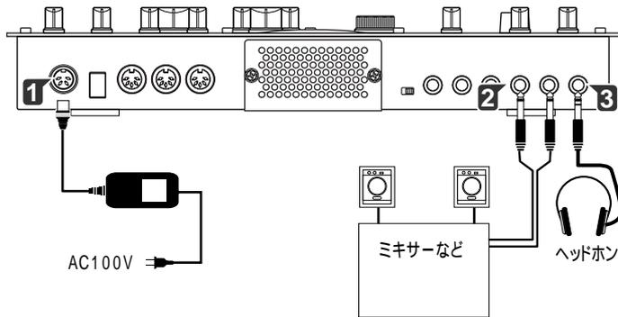
**⚠** 各接続は、必ず電源を切った状態で行ってください。不注意に操作を行うと、スピーカーシステム等を破損したり、誤動作を起こす原因となりますので十分に注意してください。
