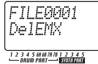
6. パラメーター・ディスプレイに“ Sure? ”と表示されます。ダイヤルを回してバリュース・ディスプレイを“ Yes ”にしてキー 13 を押してデリートを実行します。デリート実行中は進行具合がステップ・キーに表示されます。
