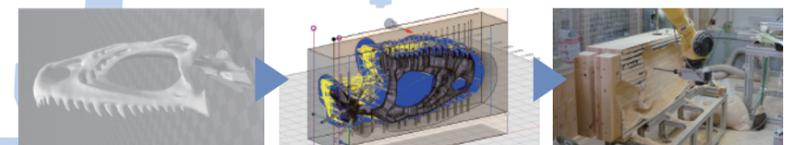
▶ ミリング加工の流れ。三次元モデルから加工パスを求め、それをロボットシステムに入力し加工を行う。
