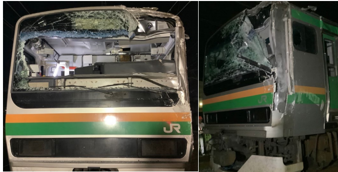
①先頭車前面損傷
