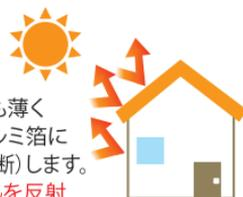
遮熱材は、断熱材よりも薄く(シート状)、表面のアルミ箔によって輻射熱を反射(遮断)します。夏は外部からの暑い熱を反射(遮断)し、室内を快適に保ちます。
