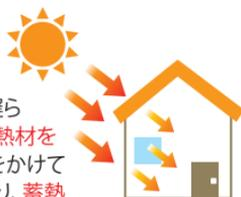
断熱材は、熱の伝わりを遅らせます。夏場の室内が断熱材を入れても暑いのは、時間をかけてゆっくりと熱が室内に入り、蓄熱効果で熱を保持しているからです。
