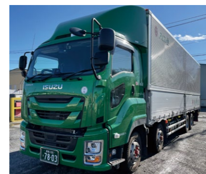
低公害車：環境対応型ディーゼル車（平成27年度燃費基準達成車 + 平成28年度排ガス基準達成車）
