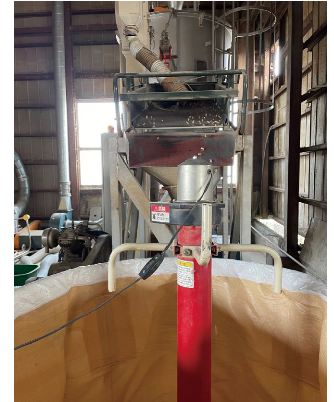
木材の加工から出たノコくずやカンナくずから生まれた、自社製「群馬しづかわ産木質ペレット」燃料
