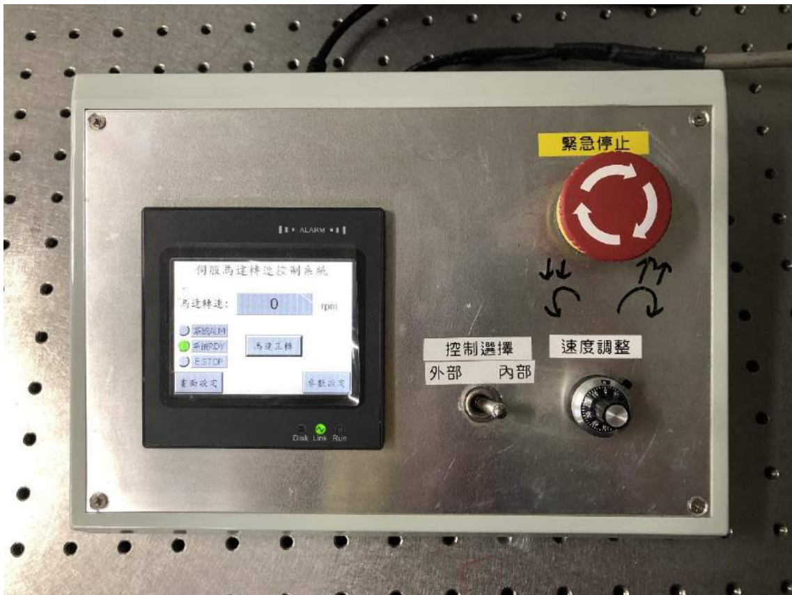
圖 6 - 5 伺服馬達控制器實體照片
