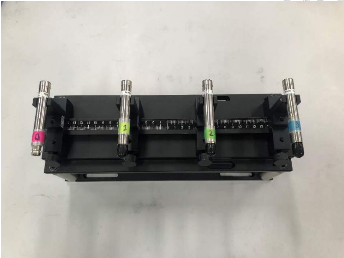
圖 3 - 16 麥克風陣列照片 ( M = 4 , d = 0.1m )
