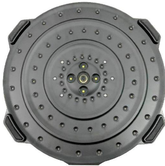
圖 4 - 15 CAE SoundCam 硬體外觀
