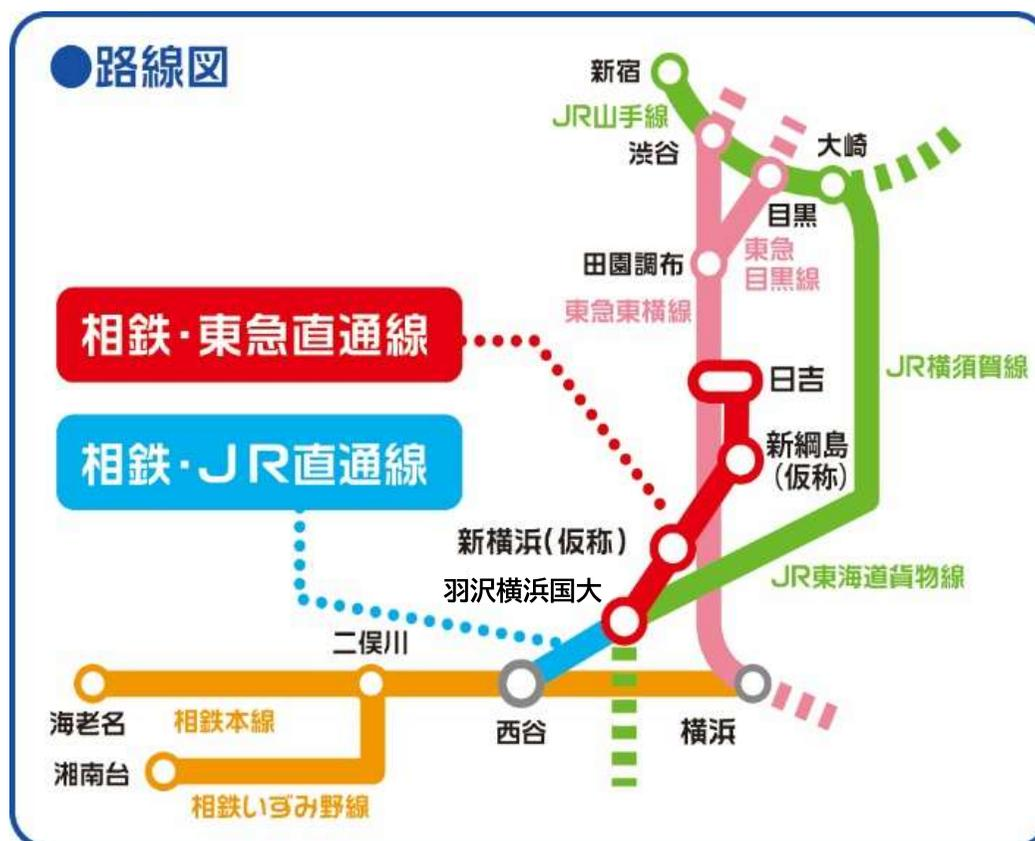
相鉄・東急直通線事業は、羽沢横浜国大駅から東急線日吉駅までの連絡線（約10.0km）を新設し、相鉄線と東急線が相互直通運転を行うものです。この路線により、横浜市西部および神奈川県中部と東京都心部が直結し、所要時間の短縮や乗換回数の減少など、交通の利便性向上を図るとともに、新幹線へのアクセスが便利になります。
