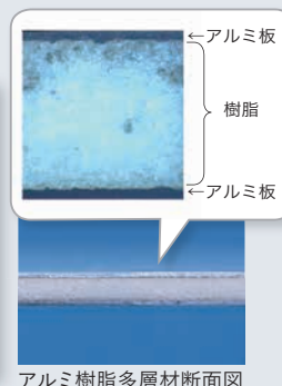
アルミ樹脂多層材断面図
