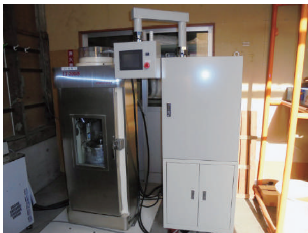
高压処理装置 L2-200/5A
