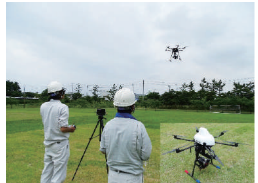
UAVに赤外線カメラを搭載して撮影中
