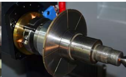
側面への溝加工
