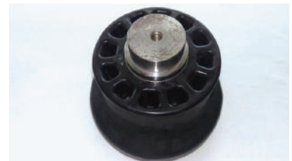
樹脂製品に金属部品をインサートした部品
