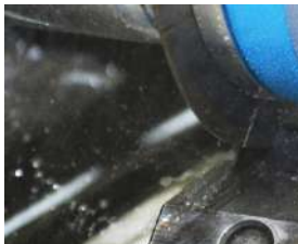
加工点に効率よく導かれた冷却水
