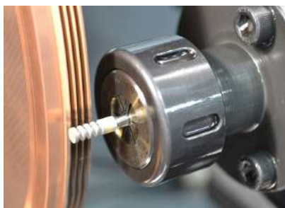
微小径砥石への溝加工
