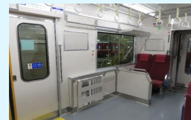
▲ 車両のフリースペース設置
