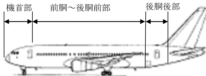
図 1.5.5 -2 胴体外板の製造工程による区分
