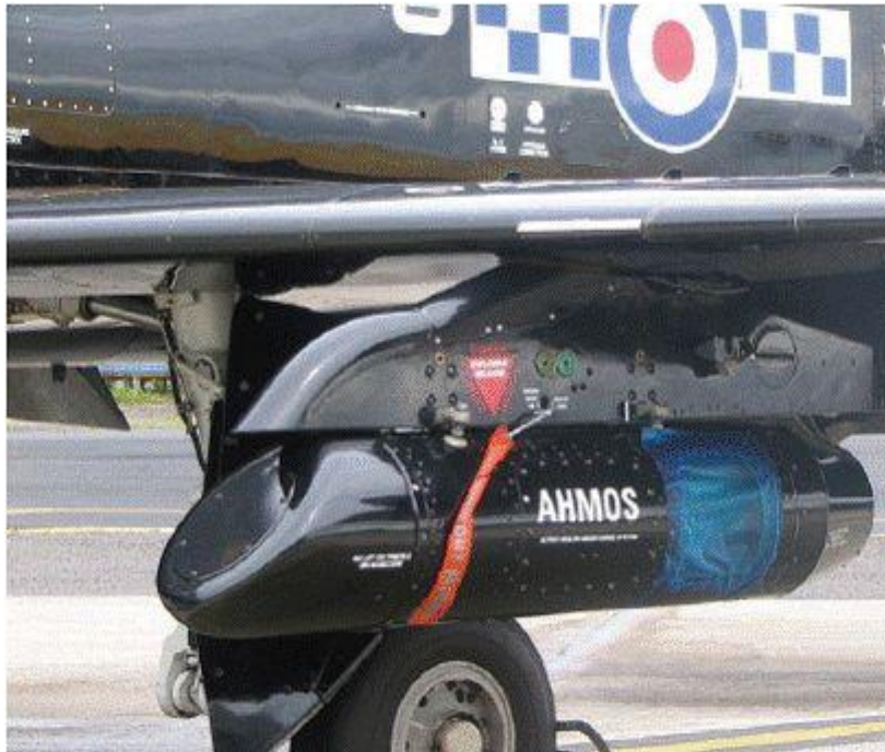
図 2.2.2 (3) - 1 T1A に搭載したセンサーシステム < Aerospace Testing International Magazine : November/December 2011 >
