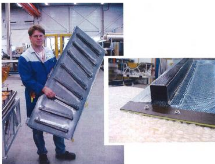
図 1.3.4 (3) - 1 A340-500/600 アクセスパネル コ・コンソリデーション技術により外板とハット型断面のスティフナを一体成形した例
