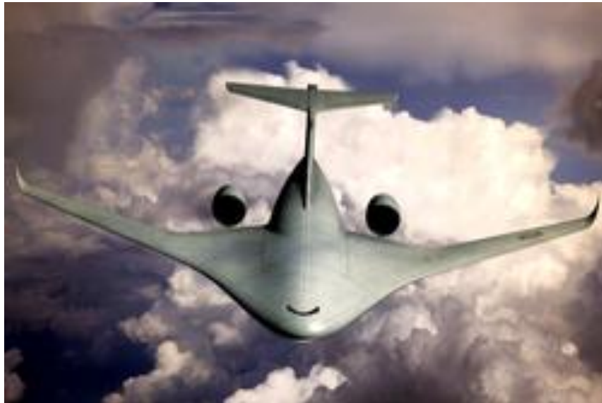
図 4.4 (5) - 1 前胴と主翼のBWB形状と通常の後胴と尾翼を結合した形状 < AW 2014/2/17 >
