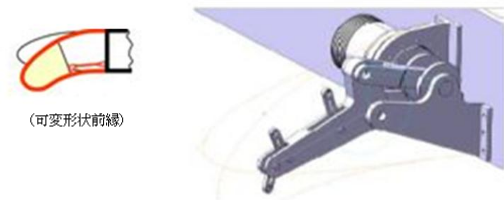
図 2.1.2 (3) - 3 可変前縁内アクチュエータ
