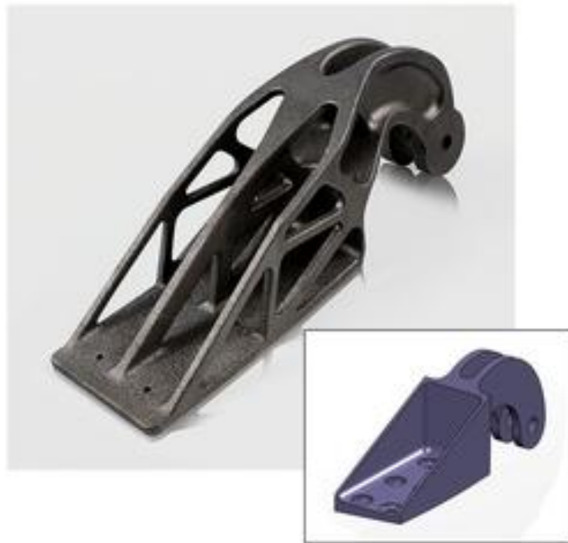
図 2.1.2 (7) - 2 Additive Manufacturing によるチタン部品 < AW 2013/11/11 >
