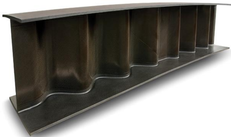
図 2.1.2 (7) - 3 正弦波形状スパーの複合材実証構造体 < FG 2012/9/2 >
