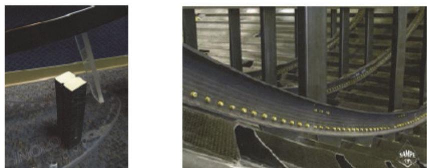
図 1.4.3 (1) – 1 フレームのプリフォームと試作品に組み込まれたフレーム
