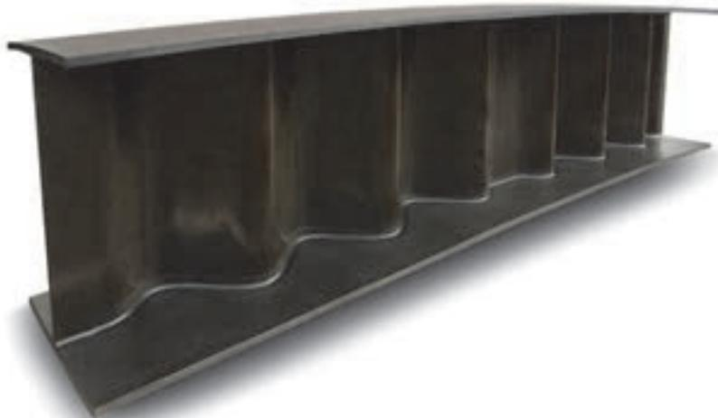
図 2.1.2 (7) - 1 正弦波形状スパーの複合材実証構造体
