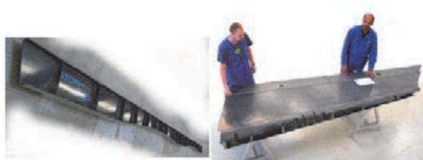
図 1.4.3 (4) - 2  $\pi$ 型フィラによるバットジョイント試作部品
