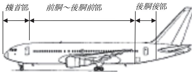
図 1.5.5-2 脊体外板の製造工程による区分
