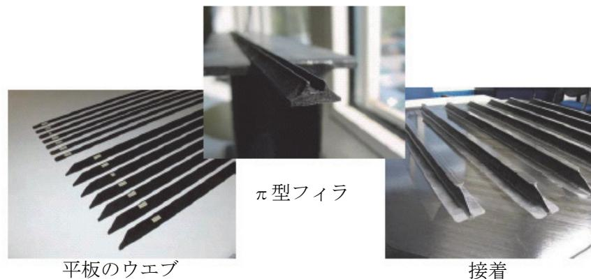
図 1.4.3 (4) - 1  $\pi$  型フィラによるバットジョイント接着構造
