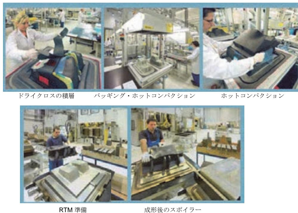
図 1.4.3 (2) - 3 スポイラーの製造
