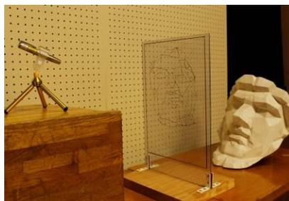
■ 図2 アクリル板とレーザーポインターを使用する現代版製図機
