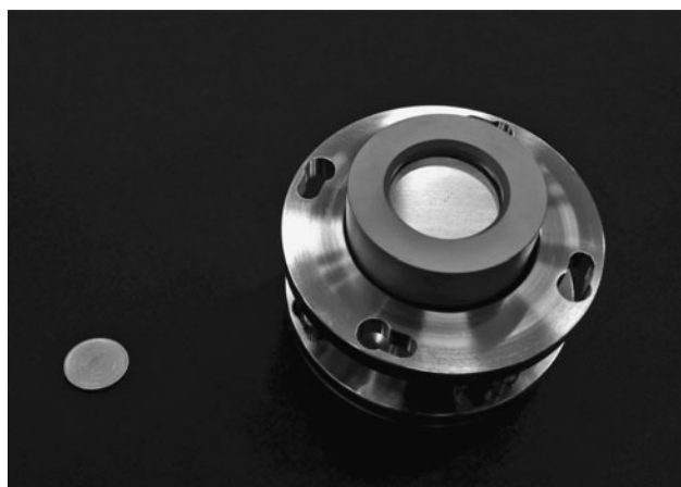
図2 ミニマルスパッタ装置用の小型マグネトロンスパッタ源。
