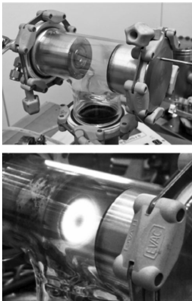
図7 高出力スパッタ源実験装置とその放電の様子。
