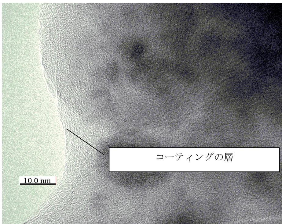
Fig. 3-48 TEMによる  $\text{Mg}(\text{OH})_2$  +薬剤コーティングの観察 (pH7)
