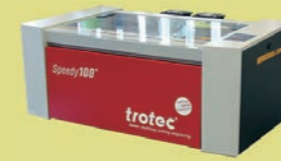
レーザー加工機 trotec Speedy100 （CO 2 レーザー）
