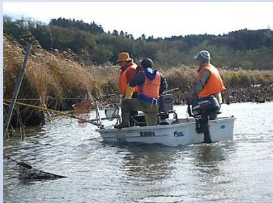
電気ショッカーボートとは、水中に電気を流し、しびれた魚を捕獲する方法です。その特徴は・・・
