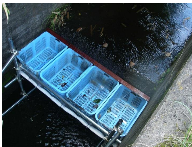
図5. 流出する魚類を捕獲するためのカゴ
