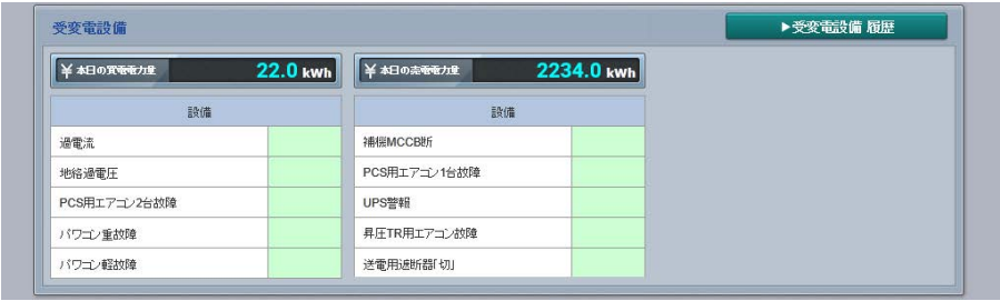
一括監視画面の受変電設備エリア
