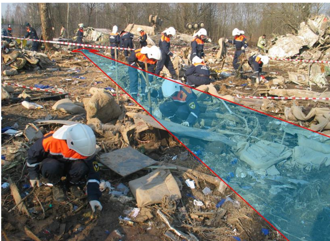
Rys. 48. Kierunek przemieszczania się szczątków prawej strony salonu nr 2 i szczątków wyposażenia znajdującego się po prawej stronie pomieszczenia kuchennego. Widoczne fragmenty plastikowych tacek znajdujących się pierwotnie w wózkach cateringowych. Foto – materiały z oględzin rosyjskich.
