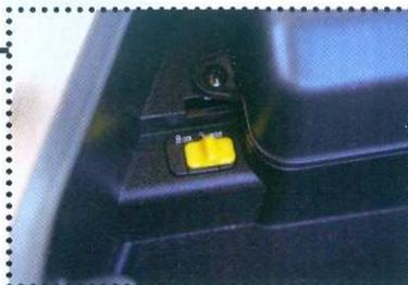
**2** A SYM desenvolveu um sistema simples e engenhoso para evitar roubos. Sob o o banco do Citycom, existe uma chave para cortar a corrente, impossibilitando ligar o scooter.
