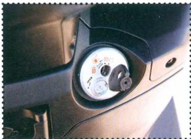
**1** A ignição do SYM Citycom 300i conta com sistema antifurto e você abre o baú da motocicleta virando a ignição totalmente para a esquerda.
