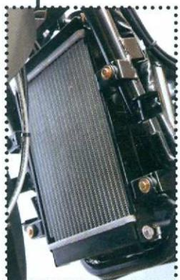
**5** Um dos grandes atrativos do Citycom 300i é o sistema de arrefecimento a líquido, que traz uma melhor performance ao motor. À esquerda, está o radiador do Citycom localizado na dianteira.
