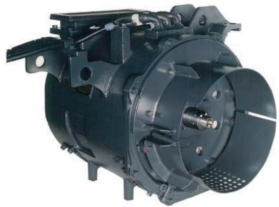
■ 図6 主電動機外観
