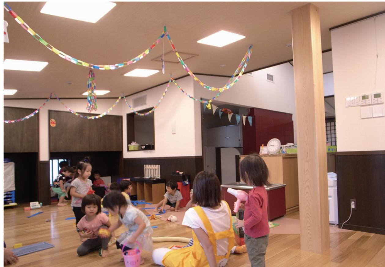
2歳児保育室。もえしる設計による木肌の美しい杉の無垢柱が屋根を支える。中央奥は受入コーナーと幼児便所、間にバスルーフ方式のよごれ物棚を設え、衛生的に管理できるよう計画した。左奥の押入下には、こどもの高さで通風を行えるよう、オペレーターで制御できる窓を設けた
