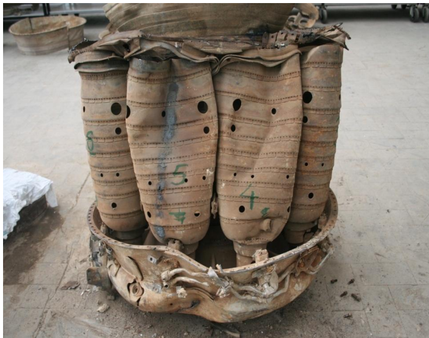
Fig.45: Cámara de combustión del motor Nro.2.
