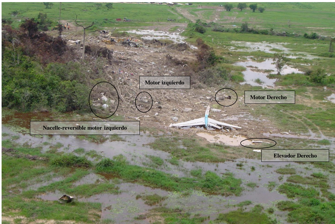
Fig. 1: La aeronave quedó totalmente destruida luego del impacto, excepto el estabilizador horizontal, el cual quedó casi completo.
