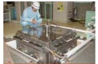
熱-水-応力連成試験設備
