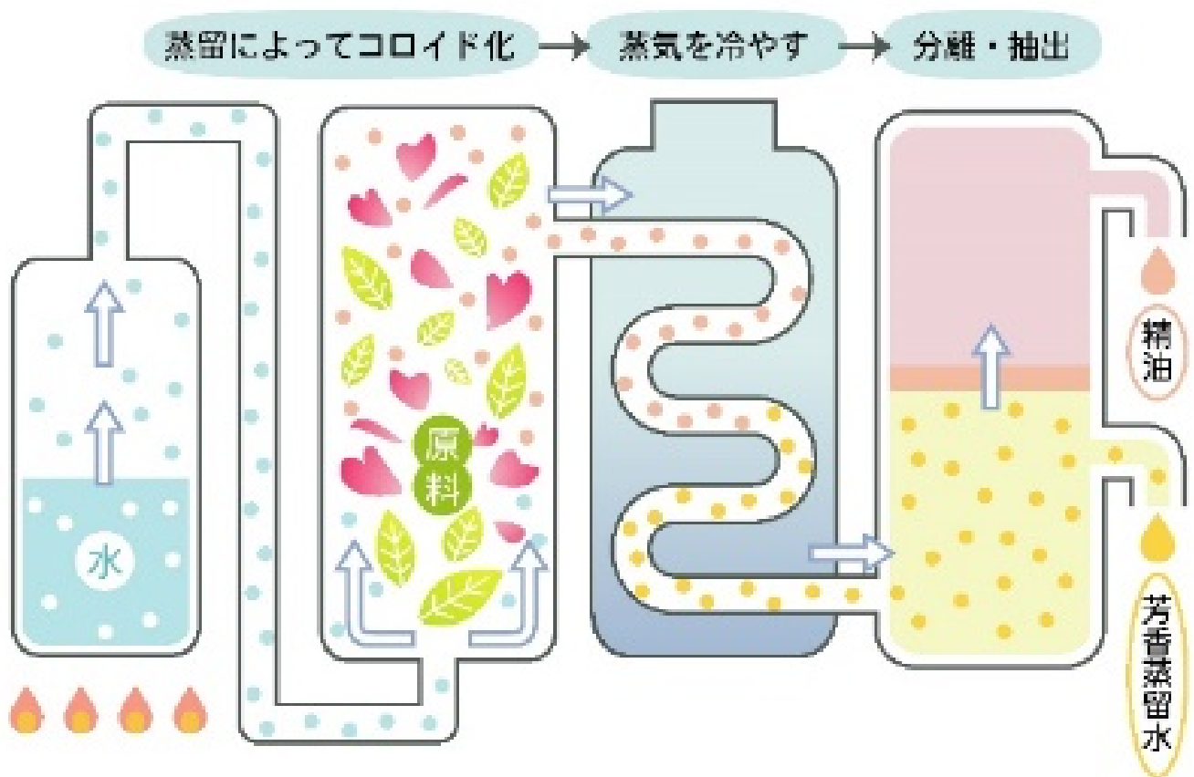
図1 水蒸気蒸留仕組み
