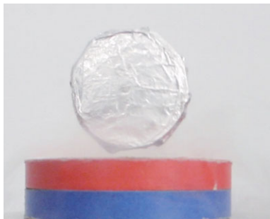
図1. 超電導による反磁性。CuBaDyO系超電導体(左)とBiSrCaCuO系超電導コイル(右)
