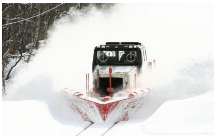
排雪モーターカーによる除雪
