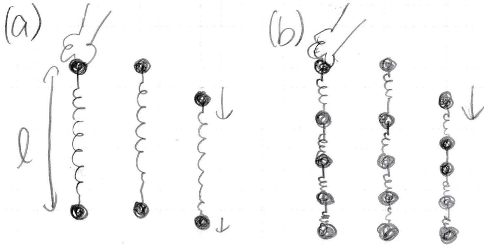
図 5.8 (a) 二つの粒子を理想的なバネでつなぎ、一方を手で持ち、もう一方は自然に垂れさがらせておく。ここで静かに手を放すと、上の粒子は 2g の加速度で素早く落下し、下の粒子は t^4 に比例してゆっくりと落下する。(b) 複数の粒子を同じ理想的なバネでつなぎ、やはり一番上の粒子を持って全体を垂れ下げておいて、静かに手を放す。
