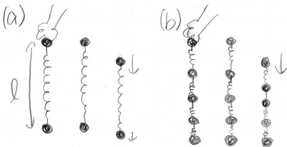
図 5.8 (a) 二つの粒子を理想的なバネでつなぎ、一方を手で持ち、もう一方は自然に垂れさがらせておく。ここで静かに手を放すと、上の粒子は 2g の加速度で素早く落下し、下の粒子は t^4 に比例してゆっくりと落下する。(b) 複数の粒子を同じ理想的なバネでつなぎ、やはり一番上の粒子を持って全体を垂れ下げておいて、静かに手を放す。
