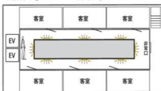
例えば、廊下に人がいないときの暗がりでは、常夜灯として 10%のほのかな点灯で節約モードになっています。エレベータや各部屋から人を検知すると通路全体が一斉に 100%点灯します。通行の必要な時だけ行く先まで自動で照らしますので安心して通行できますし、不要な電力を抑制できます。
