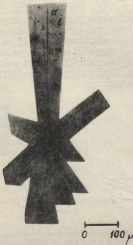
21. zīm. Kodola reakcijas reģistrēšana ar fotoplati (pallelināts uzņēmums mikroskopā). Ar \alpha apzīmēts antiprotona izraisītais nomelnojums.
