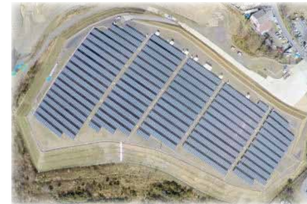
生長の家 京都・城陽メガソーラー発電所 設置場所：京都府城陽市久世奥山敷地 面積：約3万6千㎡（太陽光パネル6,408枚） 予想年間発電量：約183万444Kwh CO2削減効果：約960t
