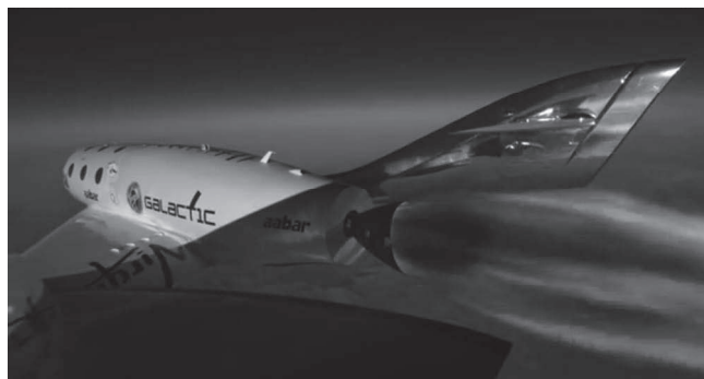
SpaceShipTwo 第3回めのパワードフライトでのハイブリッドロケットモータの燃焼の様子 (c)Virgin Galactic
