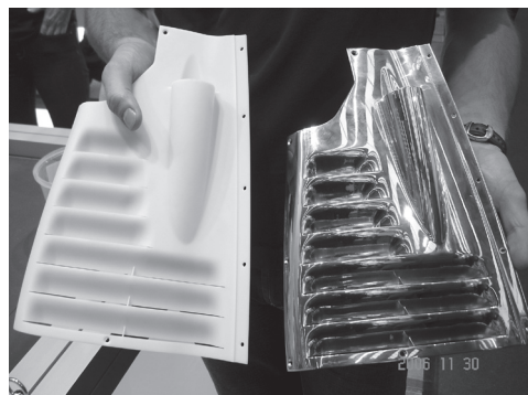
写真 5 厚膜メッキした造形物例
