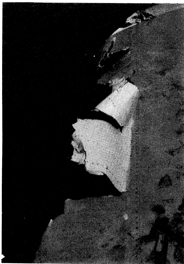
写真 5 右主翼翼端前縁部の損壊状況
