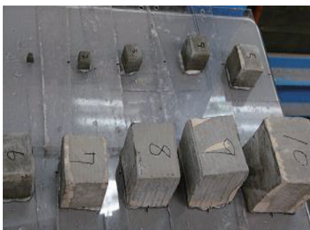
図 3 橋の上の物体を模型化したコンクリート塊。辺長 1 cm から 10 cm の立方体。
