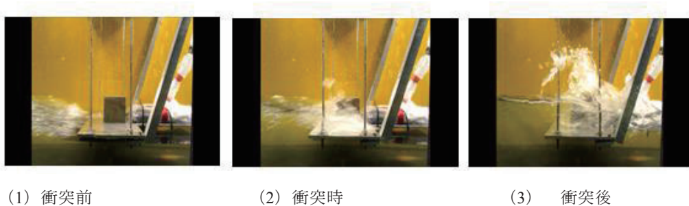
図10 ブロック辺長7 cm、Case 4 の波の衝突前後の様子
