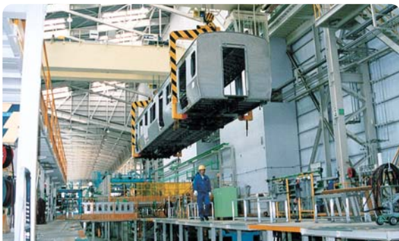
▶ 新津車両製作所は、鉄道会社が持つ国内唯一の車両製造工場。ここで年間約250両の電車が生産される
