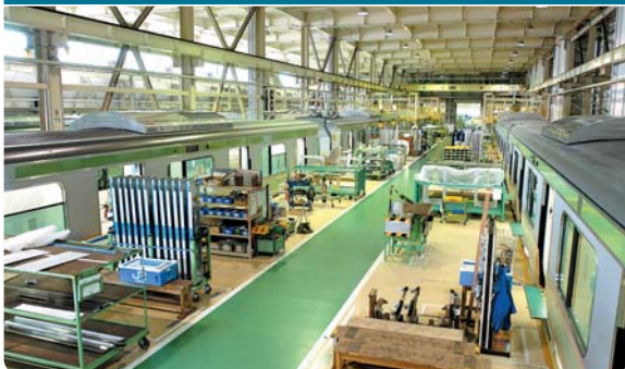
▶ 新津車両製作所は、鉄道会社が持つ国内唯一の車両製造工場。ここで年間約250両の電車が生産される
