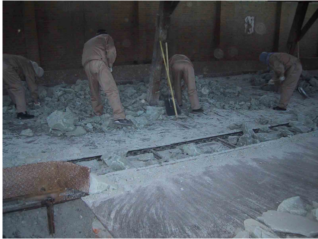
写真 3.4-17 ベントナイト鉱石の人力による選鉱作業
