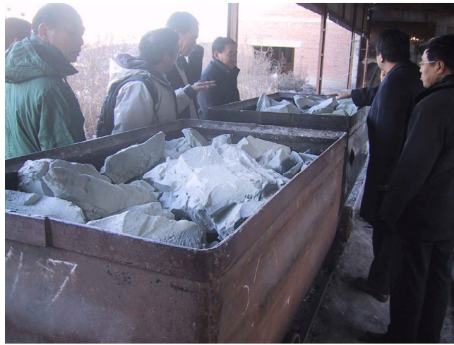
写真 3.4-15 トロッコで運搬されるベントナイト鉱石
