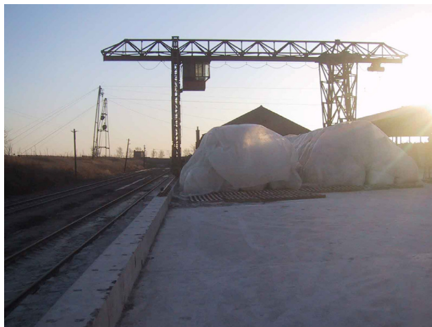
写真 3.4-19 四平劉房子ベントナイト鉱山 鉄道の引込み線と積み込み用設備状況
