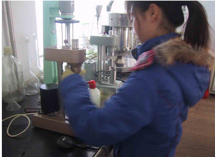
写真 3.4-13 工場内検査室。VGメーターによる粘性測定
