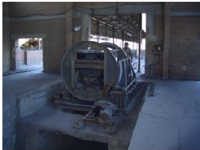
写真 3.4-16 運搬されたベントナイト鉱石をトロッコから積み替える転車台
