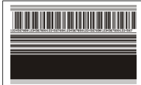
그림 17 • PAUSE( 일시 중지 ) 테스트 라벨
