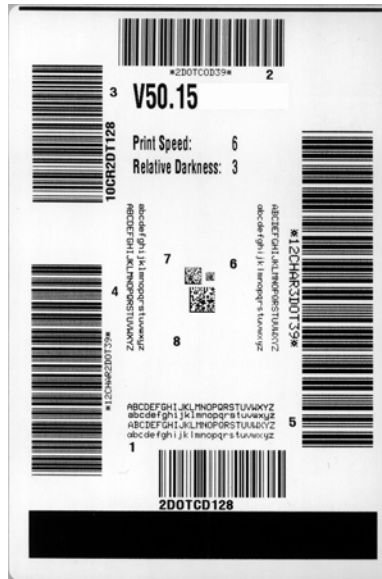
그림 18 • FEED( 급지 ) 테스트 라벨
