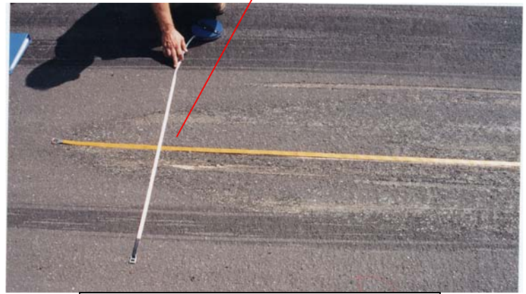
Figura 23.2 – Marcas de la góndola
