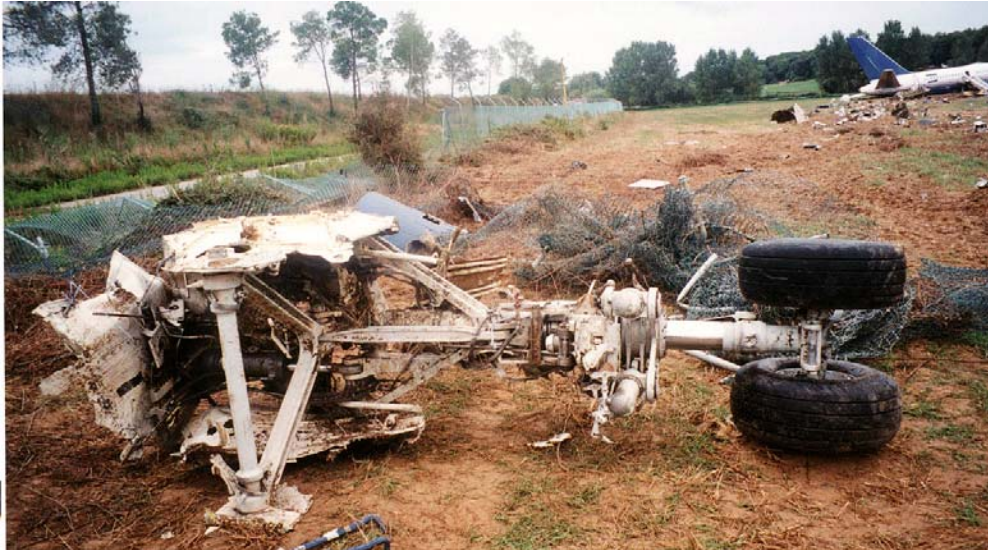
Figura 29.1 – Tren de morro unido al compartimiento auxiliar (“doghouse”)
