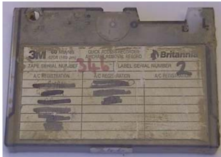
Figura 11.2 – Registrador de Acceso Rápido (QAR)
