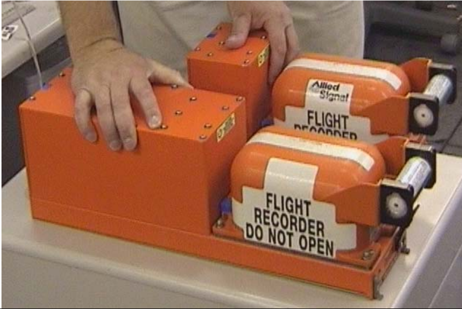
Figura 11.1 – Registradores de Datos de Vuelo y Voces en Cabina
