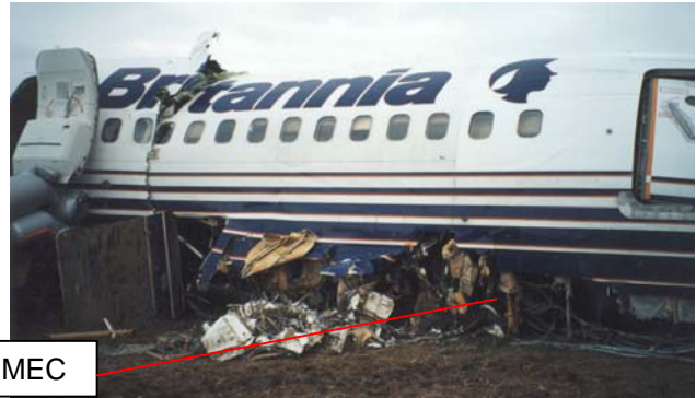
Figura 26.2 – Fuselaje delantero con vista completa del MEC
