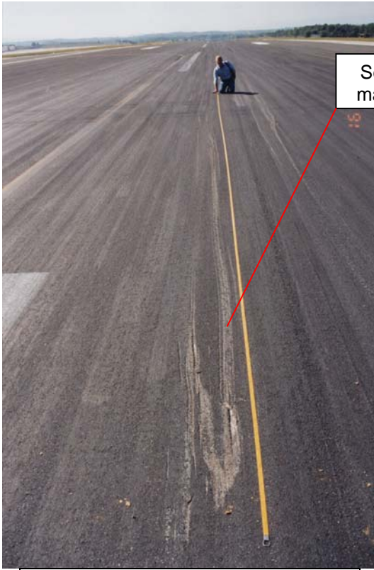
Figura 23.1 – Marcas de fuselaje
