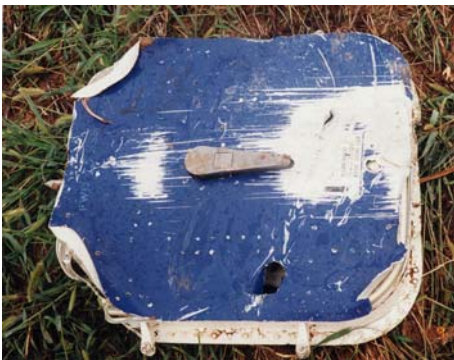
Figura 26.3 – Compuerta del centro delantero del equipo
